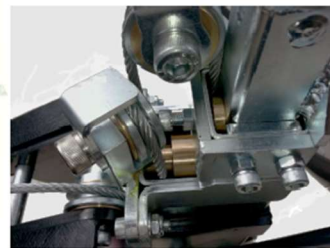
Mécanique de précision avec bagues en bronze
