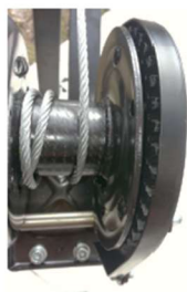
Treuil avec carter de protection pour le pignon
